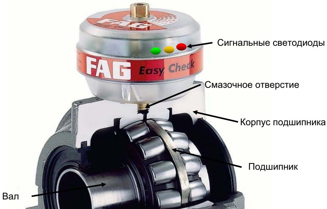
**Постоянный контроль** вибраций и температуры**«Самостоятельный прибор»** - не требует программного обеспечения**Простой монтаж** в смазочное отверстие**Возможность совместного использования** с лубрикатором**Для контроля состояния каких машин можно применять прибор?**
